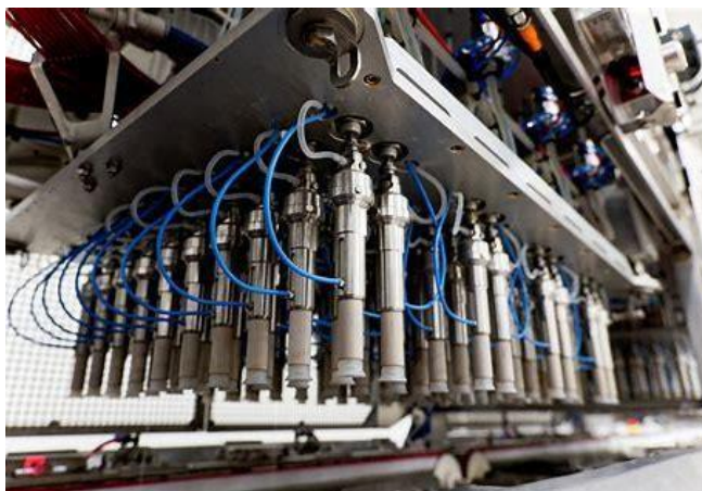
Figura 2: Equipo para vacunación in ovo
